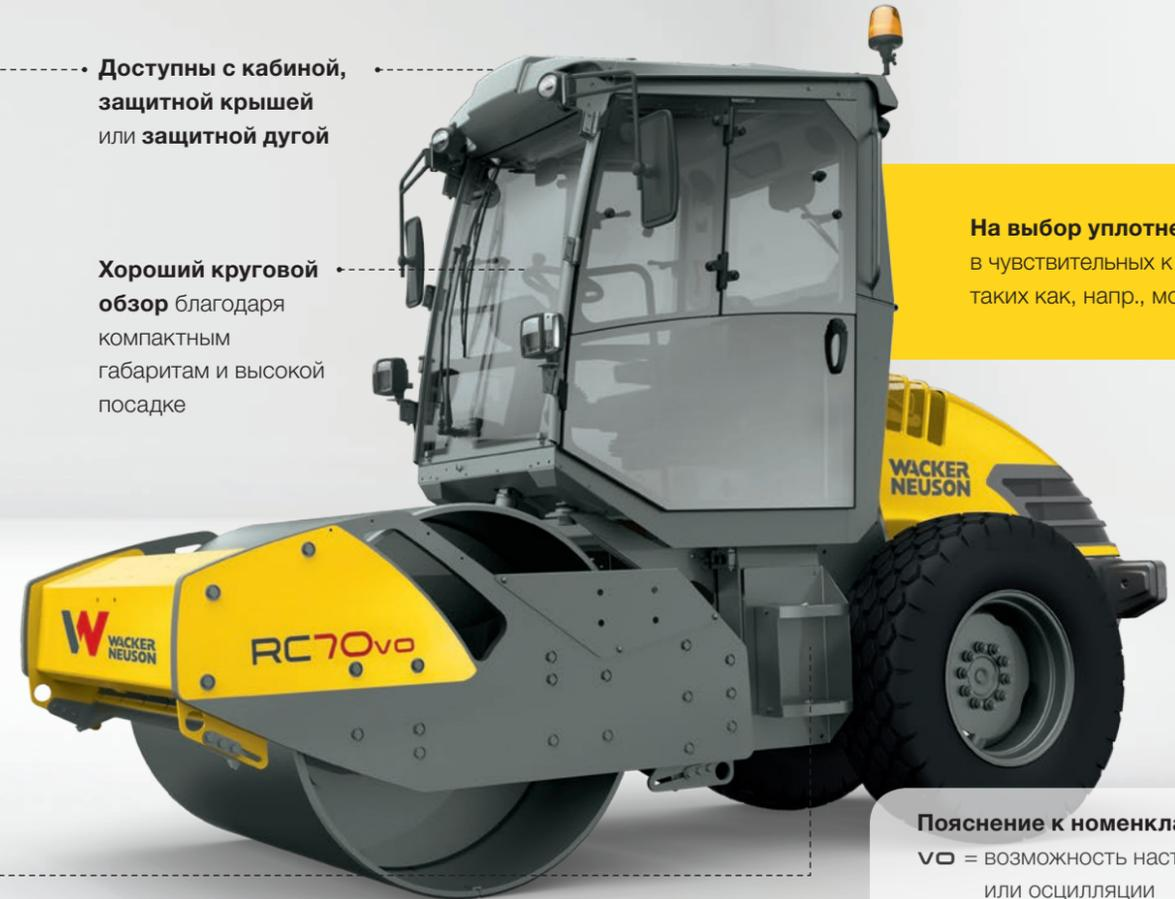
**Качающаяся опора в шарнире** защищает водителя благодаря амортизации поста управления
