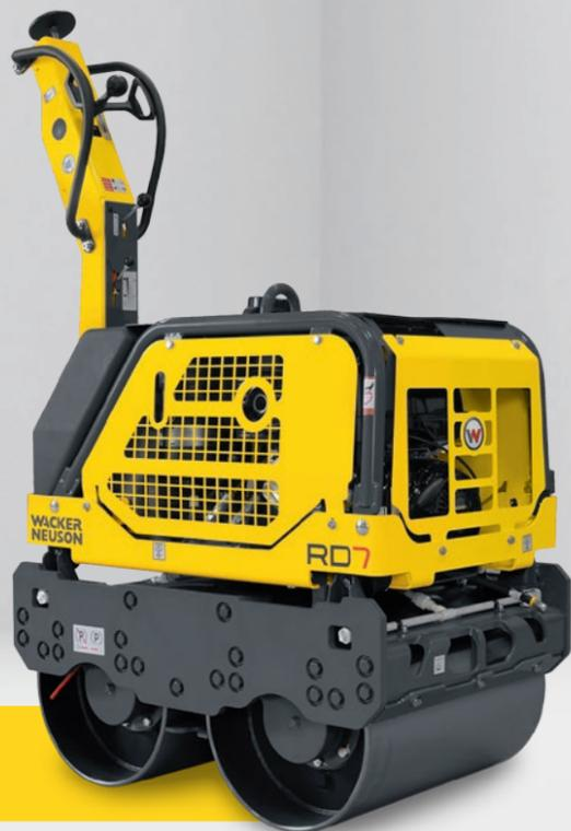
**Плавный процесс работы:** небольшое расстояние между вальцами с низким расположением центра тяжести обеспечивает простоту выполнения поворотов.
