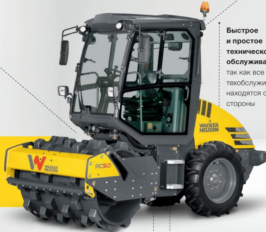
**Быстрое и простое техническое обслуживание**, так как все точки техобслуживания находятся с одной стороны
