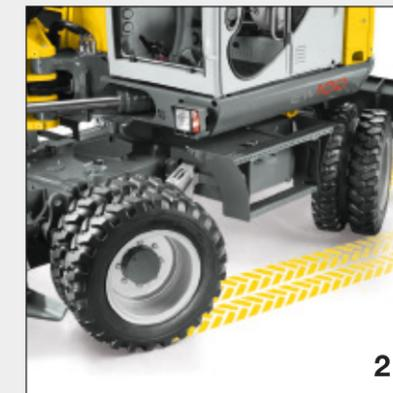
**Полноприводная система управления** для обеспечения крайне малого радиуса разворота.
