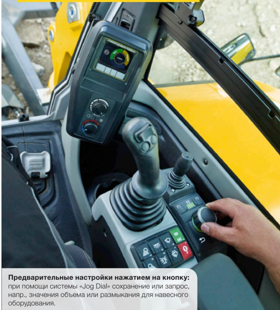
**Предварительные настройки нажатием на кнопку:** при помощи системы «Jog Dial» сохранение или запрос, напр., значения объема или размыкания для навесного оборудования.
