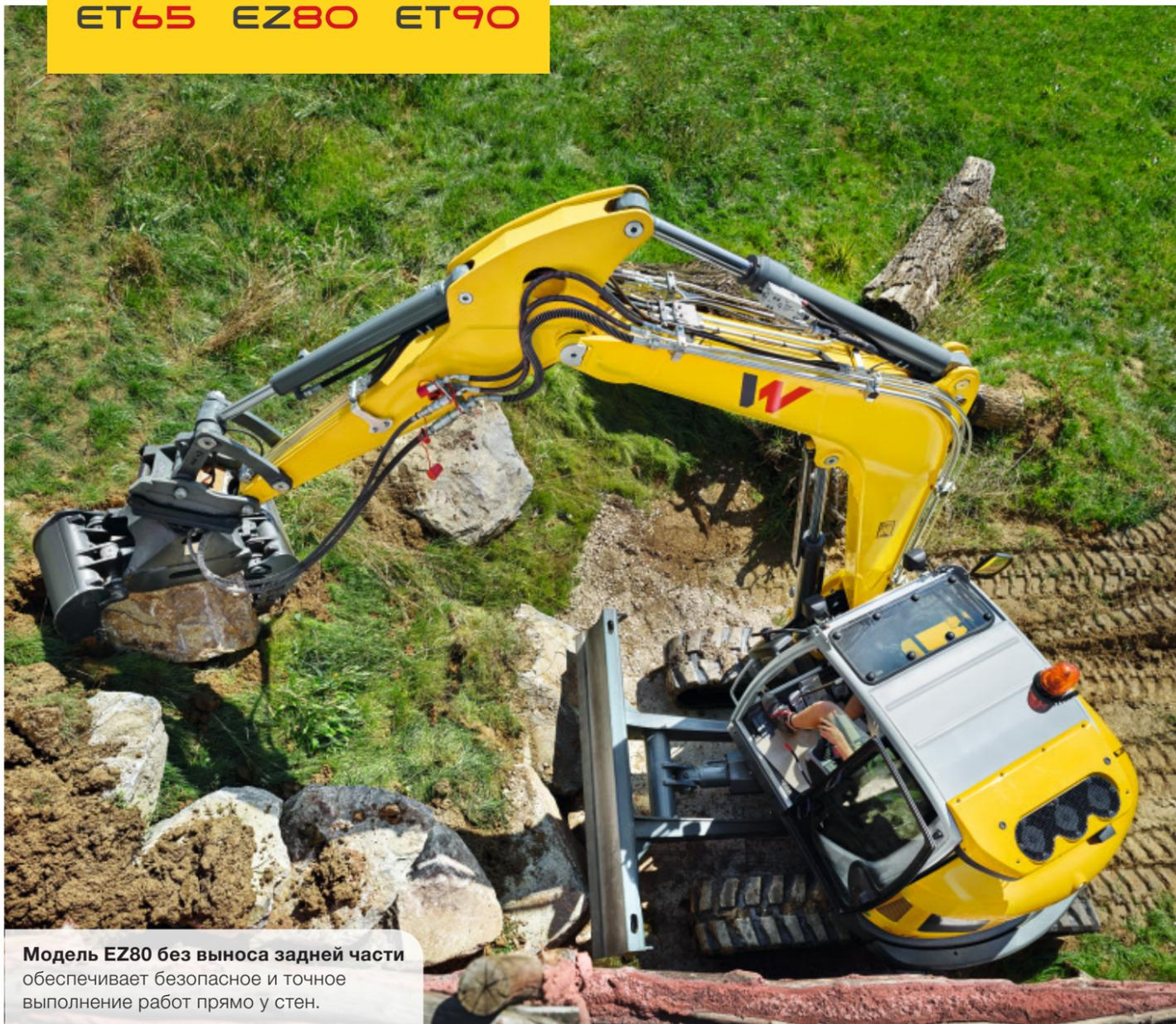
**Модель EZ80 без выноса задней части** обеспечивает безопасное и точное выполнение работ прямо у стен.
