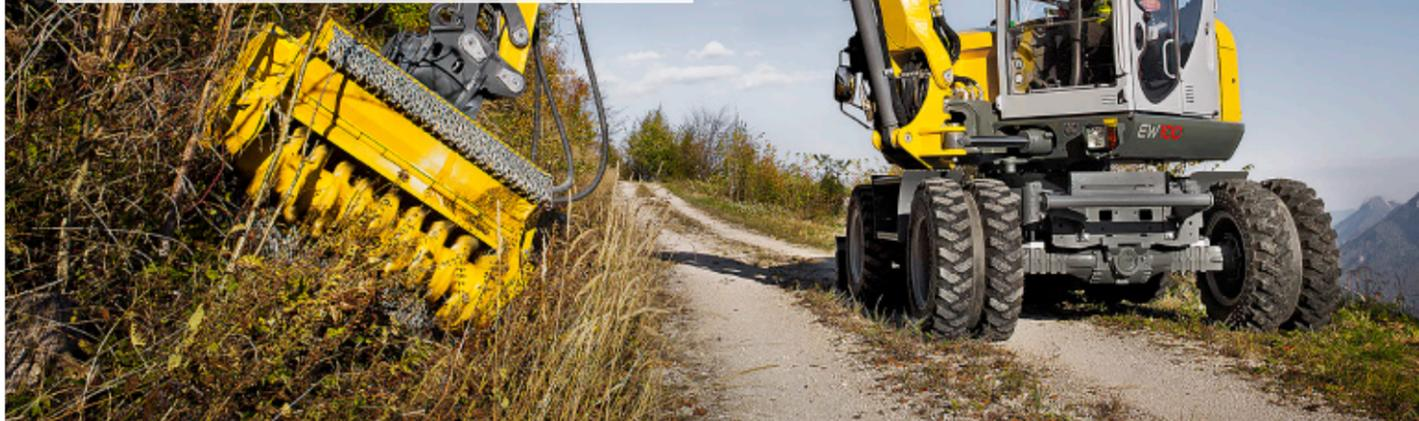
**Высокое усилие копания и большая глубина копания благодаря регулируемой стреле** обеспечивают высокую производительность выемки грунта и короткое время циклов.
